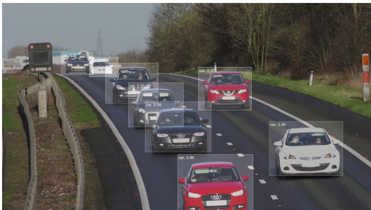
2.12-сурет – Көлік құралдарына (жеңіл автомобильдер, жүк көліктері, велосипедтер және т.б.) арналған Deep Learning негізіндегі нысанды анықтау.
